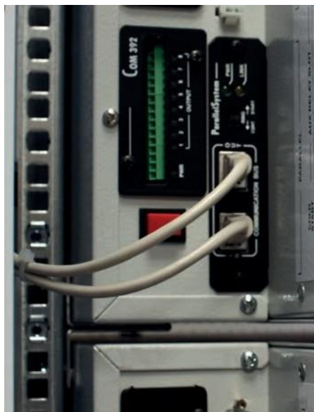
Configuration parallèle et carte de contacts de relais programmable.
